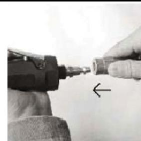
Faites glisser le levier de sécurité vers l'avant et appuyez sur le levier d'accélérateur vers le bas. Plus vous poussez le levier d'accélérateur vers le bas, plus la vitesse du meuleuses est élevée. L'appareil commence maintenant à fonctionner.
