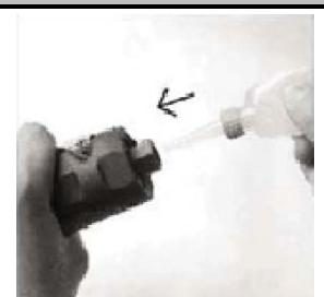
Desserrez le verrou de montage en le tournant dans le sens antihoraire avec votre main ou avec la clé fournie tout en maintenant l'arbre d'entraînement avec une clé.
