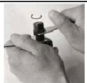
Desserrez le verrou de montage en le tournant dans le sens antihoraire avec votre main ou avec la clé fournie tout en maintenant l'arbre d'entraînement avec une clé.
