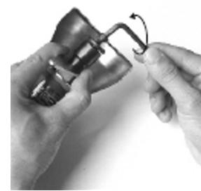
Desserrez la vis de sécurité de l'arbre en la tournant à la main ou à l'aide d'une clé dans le sens inverse des aiguilles d'une montre, tout en maintenant l'arbre d'entraînement avec une clé.
