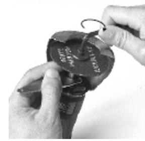
Retirez le capuchon du raccord d'air comprimé et connectez l'appareil à l'alimentation en air comprimé. Réglez la pression pneumatique à 6,2 bars (90 psi).
