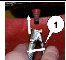
Pour remplir le pneu, appuyez la gâchette (2) de l'appareil de gonflage de pneu complètement en direction de la poignée. Relâchez de temps en temps la gâchette pour vérifier la pression d'air présente dans le pneu.
