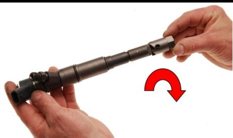
3. Insérez la fraise (1) dans le compartiment de l'injecteur et nettoyez la surface d'étanchéité de la culasse en tournant la fraise dans le sens des aiguilles d'une montre.
