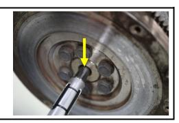
Insérer le poinçon de centrage d'embrayage dans le moyeu d'embrayage et fixer le poinçon de centrage dans le moyeu d'embrayage en tournant la molette du poinçon de centrage dans le sens des aiguilles d'une montre.
