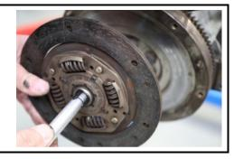
Centrer le disque d'embrayage avec le poinçon de centrage dans l'alésage du vilebrequin (roulement pilote) et monter le mécanisme d'embrayage. Attention : lors du montage du disque d'embrayage, veiller à maintenir la position de montage correcte.
