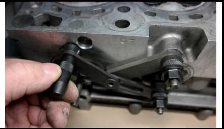
Serrez les deux écrous à six pans avec une clé de 13 mm et la vis centrale avec une clé Allen de 5 mm (20) pour fixer le gabarit sur le composant.
