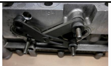
Montez deux écrous à six pans M10x1,5 (8) ou M8x1,25 (9) et serrez-les à la main.
