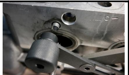
Pour ce faire, insérez la douille d'alignement appropriée (10 ou 11) dans le perçage de réception et alignez le gabarit de perçage à 3 bras avec la partie saillante du boulon fileté cassé à percer.
