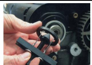
**MONTAGE (bague d'étanchéité de l'arbre à cames)**
