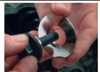
Sélectionnez la longueur et le nombre appropriés de douilles d'égalisation (1) (si nécessaire) et la douille de montage appropriée (2).
