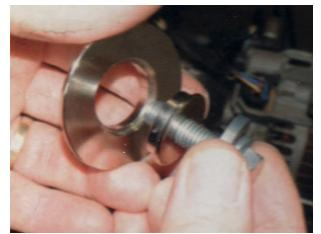
Sélectionnez la longueur et le nombre appropriés de douilles d'égalisation (1) (si nécessaire) et la douille de montage appropriée (2).
