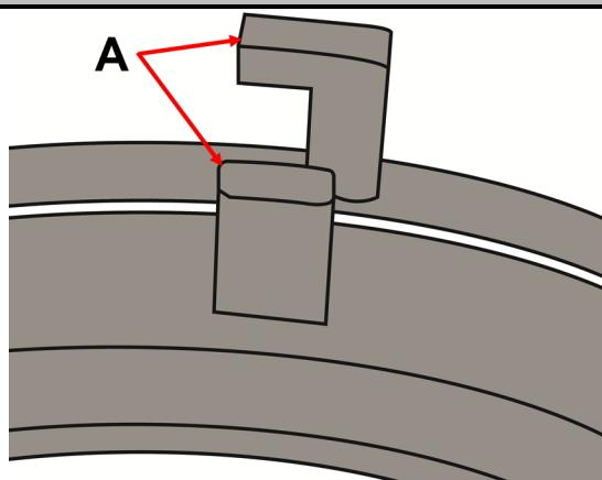
Placez l'outil de pré-tension (BGS 8284) sur l'embrayage.
