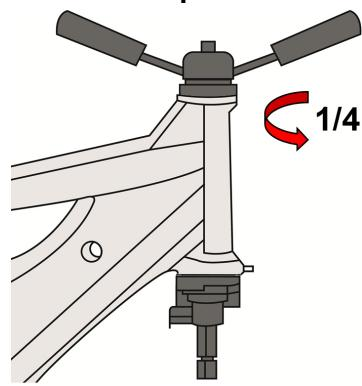
**MONTAGE DE LA COQUE DE ROULEMENT INFÉRIEUR**
