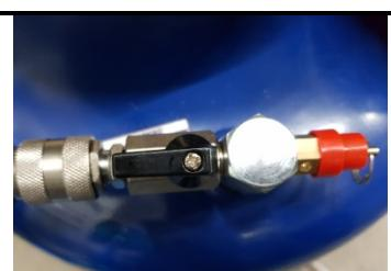
Ouvrez lentement la vanne d'arrêt sur le fond du réservoir, en vous assurant que le coude du tuyau de vidange reste dans le réservoir d'huile usagée.
