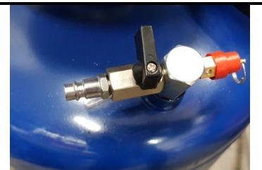
Fermez la vanne d'arrêt au bas du cylindre de mesure.
