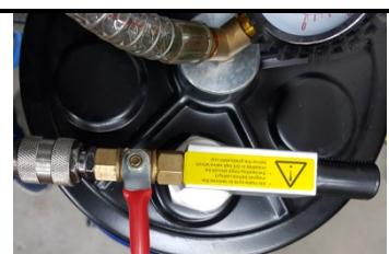
Fermez la vanne d'arrêt sur le tuyau d'aspiration (2).
