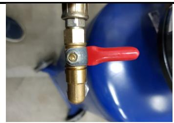
Fermez la vanne d'arrêt située au bas du cylindre de mesure.
