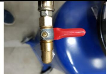
Raccordez l'alimentation en air comprimé au raccord pneumatique (3) et ouvrez la vanne.
