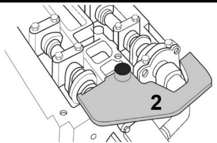
Pour les véhicules construits à partir de mai 2011. Pour insérer l'outil de réglage d'arbre à cames, il peut être nécessaire de tourner légèrement l'arbre à cames.
