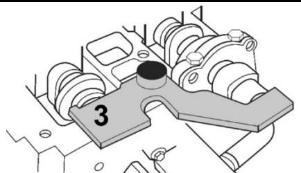
Utilisé pour aligner le capteur de vilebrequin (a) lors de l'installation du capteur ou de la poulie de courroie (b). Le capteur peut être ajusté à l'aide des trous allongés dans le support.
