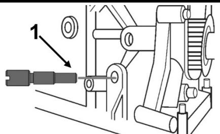
Pour les véhicules construits jusqu'en mai 2011. Pour insérer l'outil de réglage d'arbre à cames, il peut être nécessaire de tourner légèrement l'arbre à cames.
