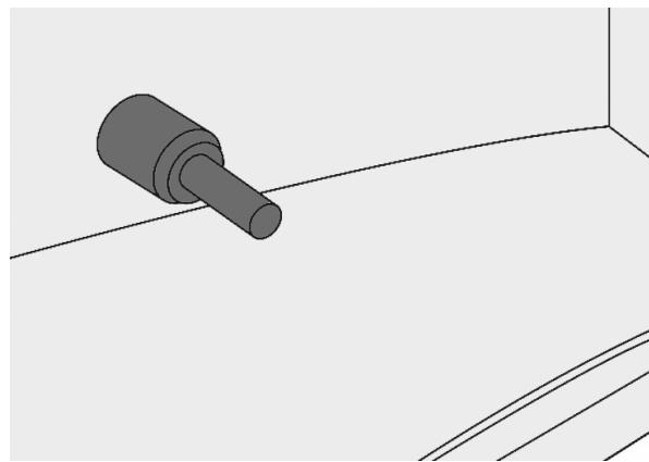
Veuillez appliquer une quantité suffisante d'adhésif aux emplacements prévus du support. Placez ensuite le support comme indiqué dans les illustrations. La fixation définitive est assurée par l'étrier de serrage noir et un écrou moleté.
