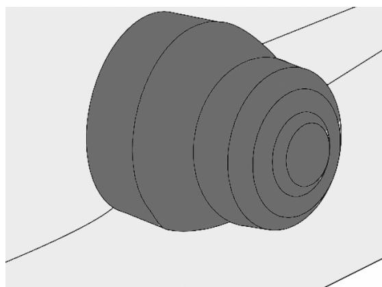
Tournez la vis dans le sens des aiguilles d'une montre avec un outil approprié, en vous assurant que la contrepartie du poinçon à l'extérieur reste en position et ne tourne pas.
