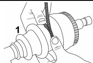
La bride doit tourner facilement dans le guidage pour soufflet de joint universel.
