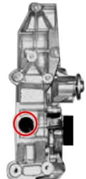
permet d'insérer le bouchon d'étanchéité
