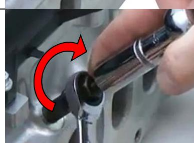
La pointe de la bougie de préchauffage est ainsi extraite vers le haut et pourra finalement être retirée, avec la tige et l'écrou d'extraction, hors du boulon de guidage.
