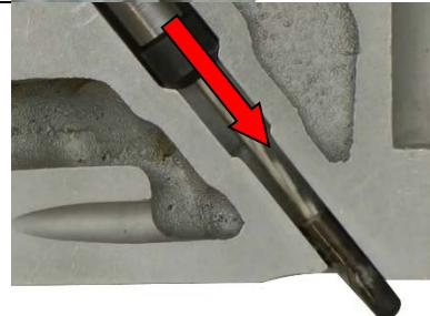
Créez un filetage dans la pointe de la bougie de préchauffage percée à l'aide du taraud approprié.
