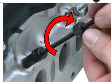
Installez l'écrou d'extraction (**8**, **9** ou **10**) sur la tige d'extraction, puis vissez-le contre le boulon de guidage à l'aide de l'outil approprié.
