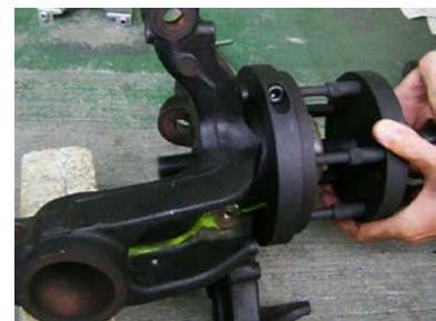
Appliquer la broche (1) avec plateau de pression monté (2) par l'avant de sorte que les goupilles de pression (3) s'appliquent sur les disques de démontage (4) au travers des alésages pour goujons de roue.
