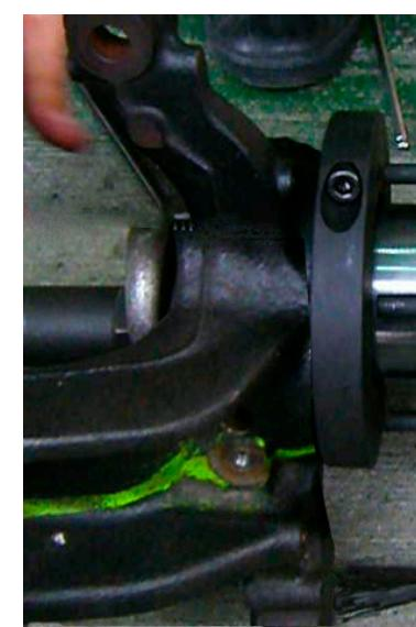
Extraire l'ancienne unité moyeu-roulement en faisant tourner la broche de pression (1) et maintenant l'écrou de broche (7).
