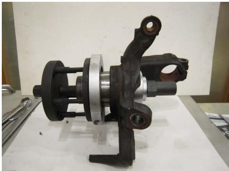
Enfoncer le roulement de roue à l'aide de la broche de pression (1) et de l'écrou de broche (7).
