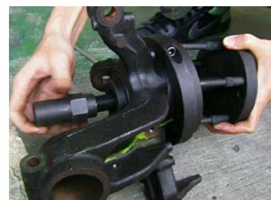
Emmancher le plateau de pression de démontage (7) côté arbre de transmission sur la broche et serrer au préalable à la main toutes les pièces avec l'écrou de broche (8).
