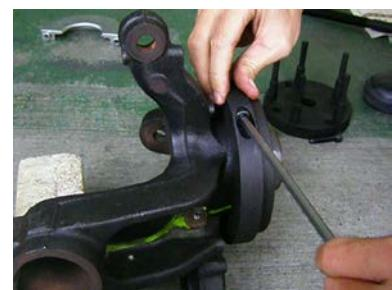
Enfoncer en frappant avec précaution les goupilles de pression (3) à l'aide d'un maillet dans le plateau de pression, les goupilles de pression (3) devant être positionnées au même entraxe que les alésages du moyeu de roue.
