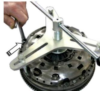
Dévissez les vis de serrage restantes du mécanisme embrayage au volant.
