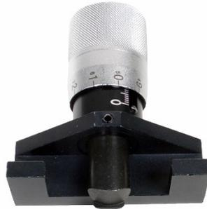
Cet outil de réglage de tension pour courroie crantée permet de mesurer, de régler et de remplacer des courroies crantées en mesurant le jeu de la courroie d'entraînement lorsqu'elle est soumise à la charge (Nm). L'outil de réglage de tension pour courroie crantée peut être utilisé sur des courroies crantées de différentes tailles. (Si l'épaisseur est supérieure à 5 mm, comparez les valeurs du tableau ci-dessous.)
