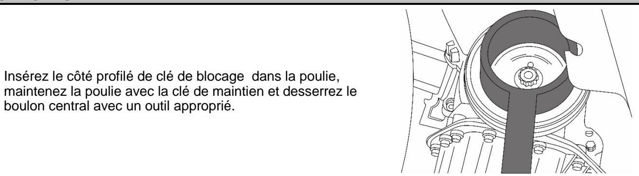
Insérez le côté profilé de clé de blocage dans la poulie, maintenez la poulie avec la clé de maintien et desserrez le boulon central avec un outil approprié.
