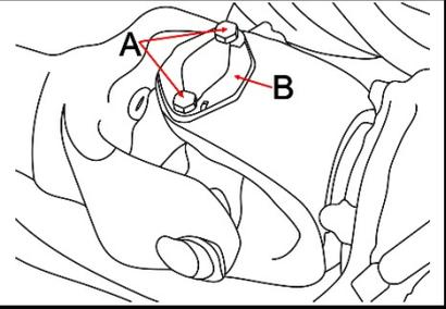
2. Placez l'outil sur le joint universel et tournez l'écrou de broche dans le sens inverse des aiguilles d'une montre.
