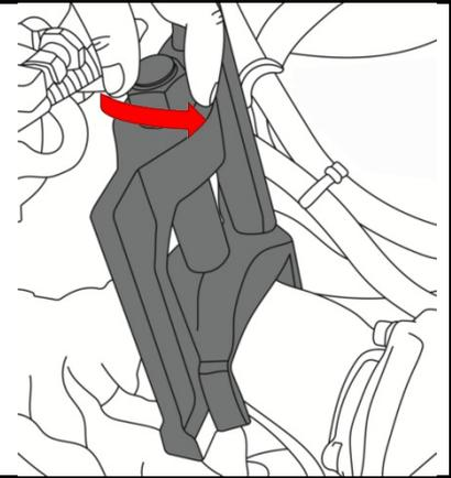
4. Tournez l'écrou de broche dans le sens des aiguilles d'une montre et retirez l'outil.
