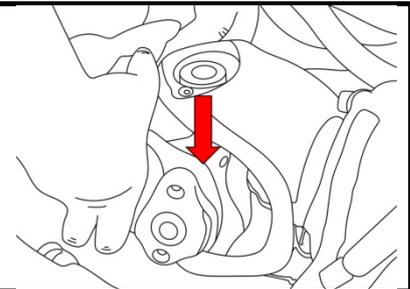
6. Faites pivoter le joint universel de 90 degrés.
