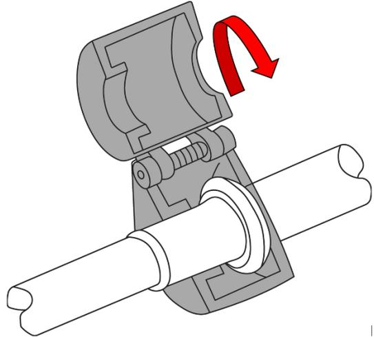
Le ressort (B) de verrouillage sert à sécuriser et à maintenir ensemble les deux durites. Il doit être écarté pour le démontage.
