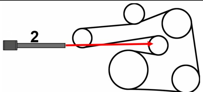
Goupille de fixation pour tendeur de courroie d' entraînement d' agrégats auxiliaires (2), pour bloquer le tendeur de la courroie d' entraînement auxiliaire en position complètement rétractée.
