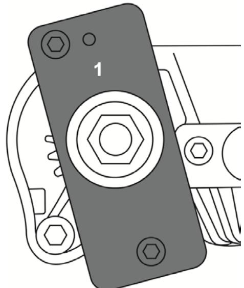
Outil de fixation pour poulie de pompe haute pression (1), pour le calage de la poulie de la pompe haute pression à la position de réglage.
